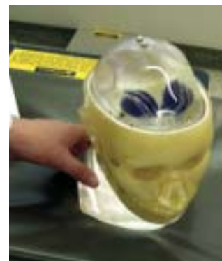
Das Phantom: Das Plexiglas-Gebilde ist eine originalgetreue Nachbildung des Gehirns und der daran anhängenden anatomischen Strukturen.
